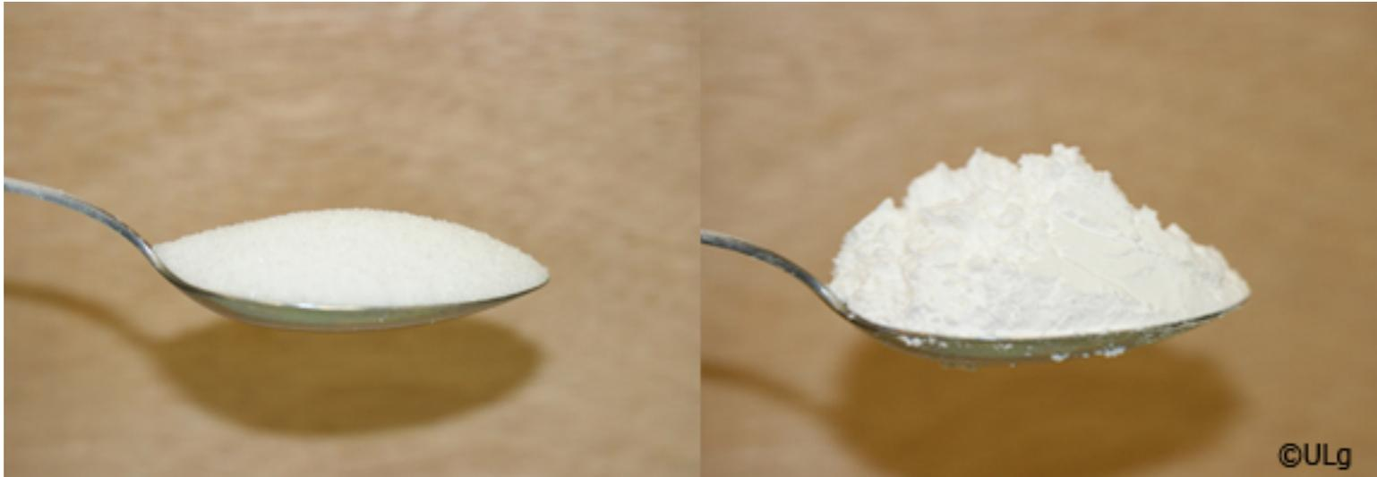
*La cohésion peut avoir des origines diverses, comme l'humidité ou les charges électrostatiques. Lorsque les forces de cohésion sont inférieures au poids d'un grain, des grumeaux se forment. La poudre est alors dite cohésive. Par exemple, le sucre fin (gauche), dont la taille des grains est de l'ordre du millimètre, n'est pas cohésif, tandis que le sucre impalpable (droite), dont la taille des grains est de l'ordre de 50 micromètres, l'est.*
